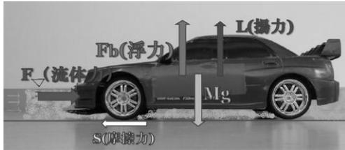
図-2 車模型に働く力
