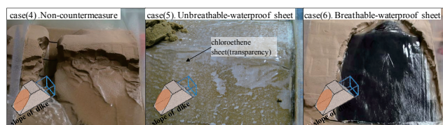
図-11 越流時の堤体の変状
