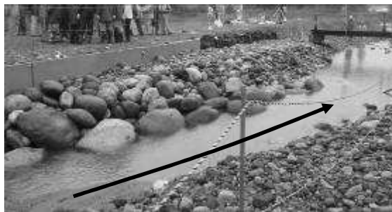
写真-16 水衝部②3回目通水後 殆ど変化無し
