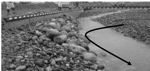
写真-15 水衝部①3回目通水後 巨石付き砂州変形無しの状態
