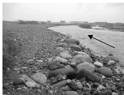
図-4 巨石付き盛土砂州の現地パイロット試験
