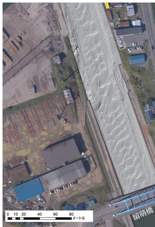
図-10 留萌開発建設部によるマルチビーム測量観測結果（2011 年 12 月 14 日）の標高値に対する陰影図
