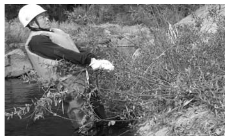
写真-3 試験植栽による安全機能（ロープの代用）の確認
