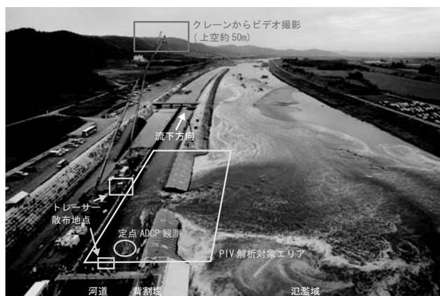
図-4 PIV 観測状況 (Case2・越水開始 36 分後の状況)
