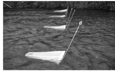
図-2 ネット設置状況の一例(ドリフトネットの設置)
