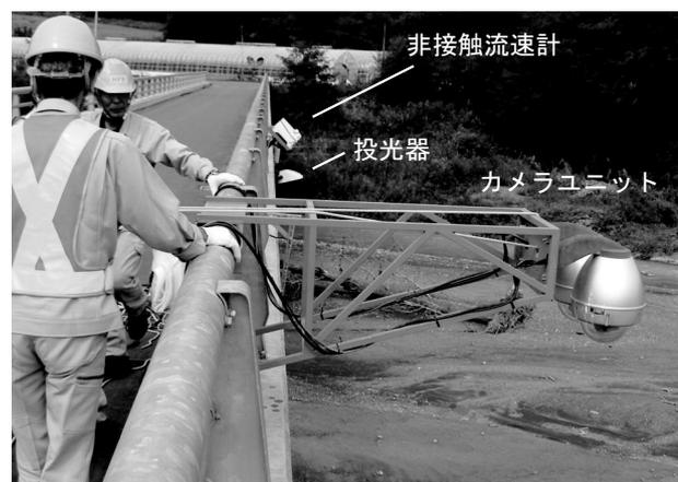
図-4 アブシトエナイ橋での可搬型システム架台設置状況
