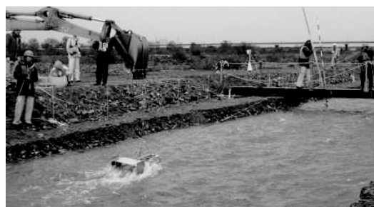
写真-2 改良H-S samplerによる流砂観測状況 (通水5回目)
