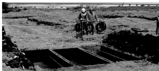
写真-3 掃流砂捕捉箱
