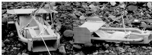
写真-1 改良H-S sampler
