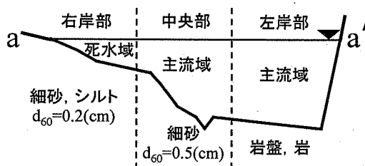
図-3 十王川調査地点の断面図と河床構造
