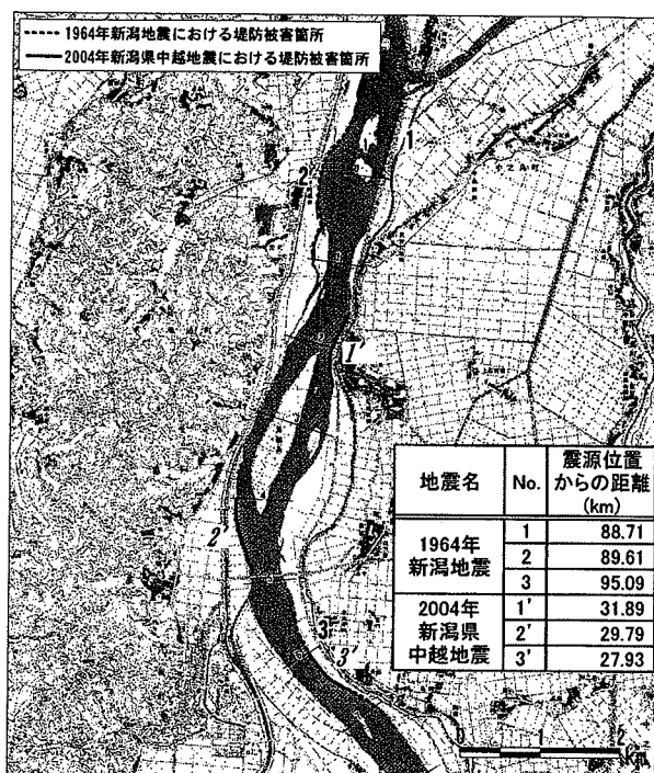
図-7 信濃川 0~7km 区間における被害箇所 2), 4)
