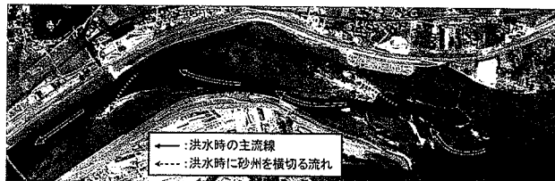
図-14 洪水流が砂州を横断する箇所でのヤナギの不定着
