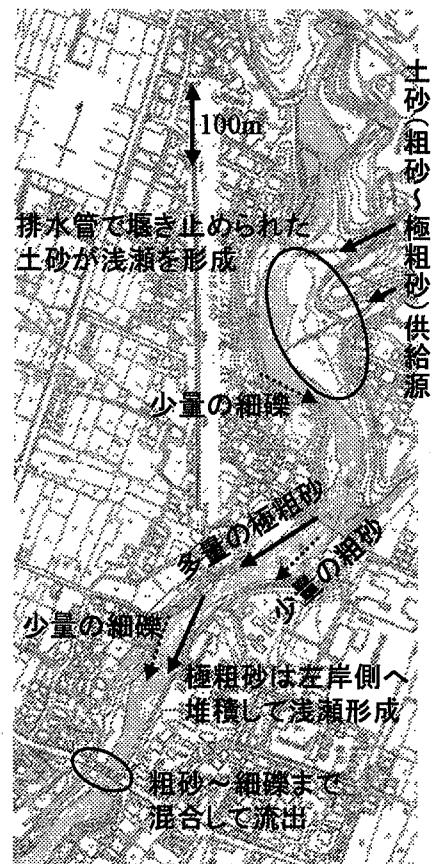
図-8 柿田川における河床材料の動態
