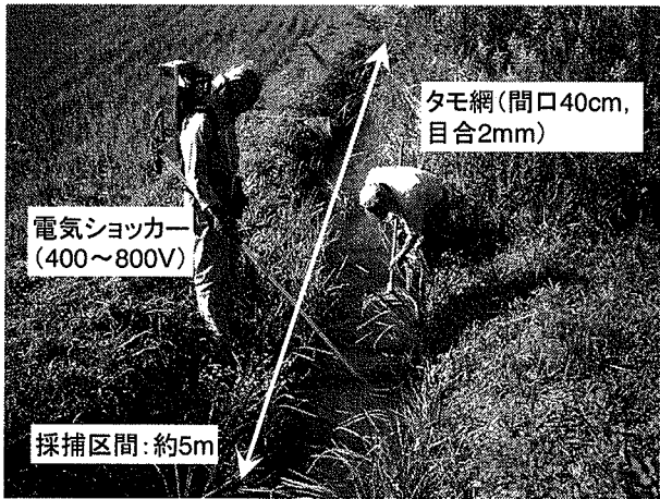
写真－2 電気ショッカーとタモ網を用いた魚類採捕
