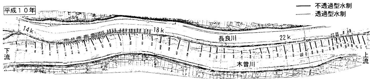
図-2 木曽川における水制の配置
