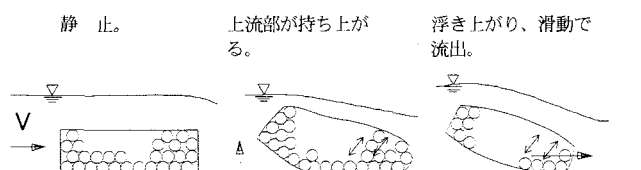
図-3 箱型袋体工の滑動（小粒径の場合）
