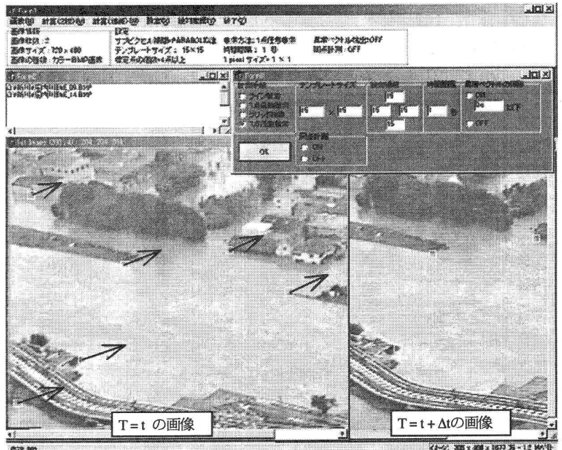
図-4 開発したアプリケーションのユーザーインターフェイス画面 (図中の矢印は地形移動ベクトル)
