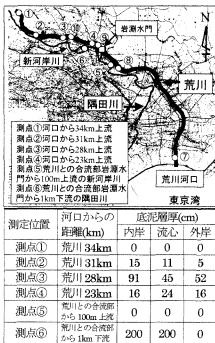
図-8 荒川における測定点を示す観測位置図と各側線における横断河床形状および底泥層厚 (底泥層厚は外岸側よりも内岸側で大きな値を示している)
