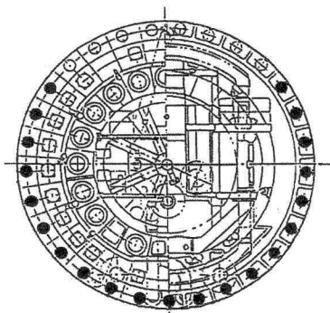
図-13 計測セグメント次リング推進時のジャッキ状況
