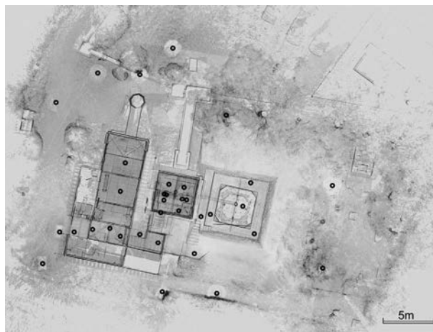
図-2 龍ヶ池揚水機場内でのレーザスキャナの設置箇所
