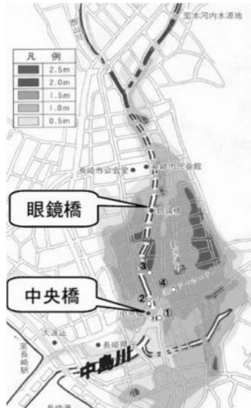
図-4 中島川周辺の冠水状況
