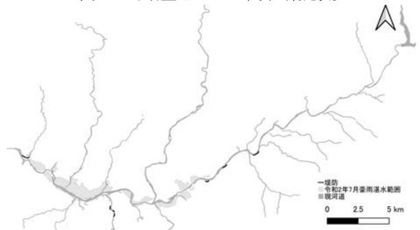
図-11 球磨盆地の1907年頃の築堤状況
