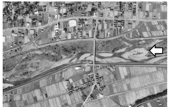
図16 霞堤の現況(三峰川 伊那市童東橋付近、国土地理院空中写真 CB982Y-C1B-14 矢印が流れ方向)
