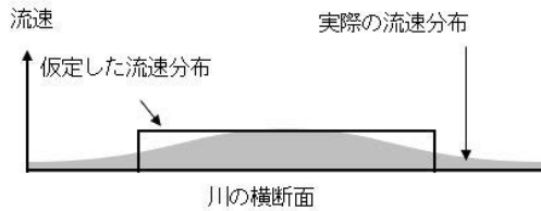
図-13 伏流水の流速分布
