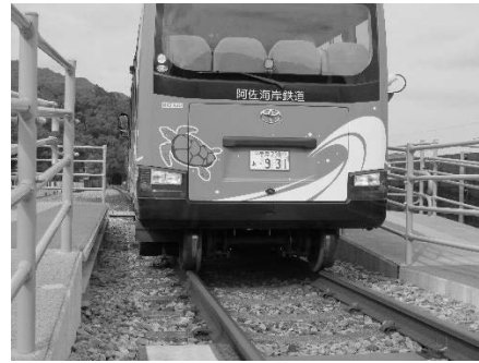
写真 13 鉄道モード レールと車輪
