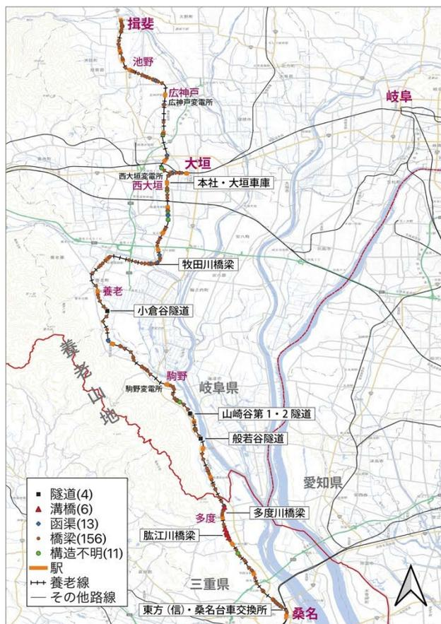
図-2 養老線路線図と土木構造物・主要施設の分布
