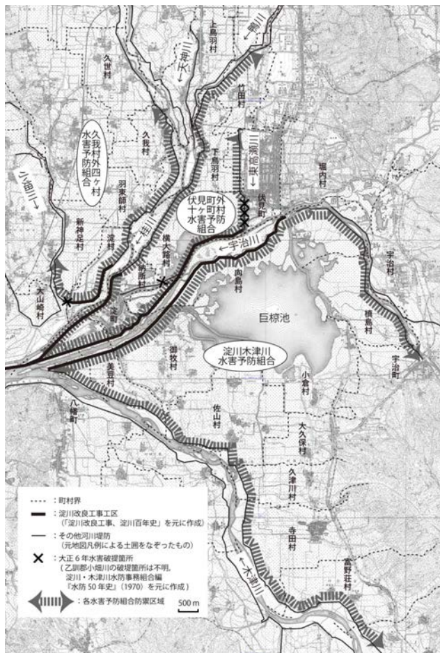
図-1 1919（大正8）年に設立された3つの水害予防組合の防禦区域と当時の堤防 （1/20000「京都南部」「膳所」「淀」「宇治」（明治42年測図）「田邊」「郷之口」（明治41年測図）上に加筆，地図は時系列地形図閲覧サイト「今昔マップ on the web」より閲覧）
