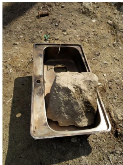
写真-12 石材運搬用の廃流し台
