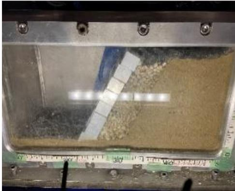
写真-3 振動後模型断面 (勾配 60°)
