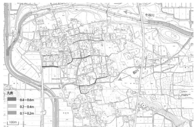
図-21 氾濫解析における道路浸水深の傾向
