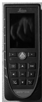
図-1 1 石垣傾斜測定
