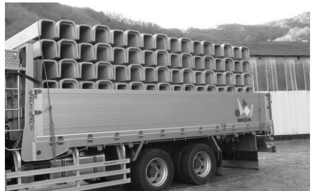
写真-5 道路整備用に福山市から支給されたU字溝
