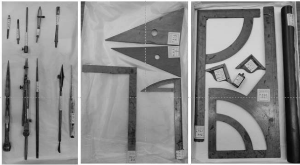
写真. 16 東福寺泰作の製図器具（信濃教育博物館所蔵 コンパス、鳥口、曲尺、分度矩など20点）
