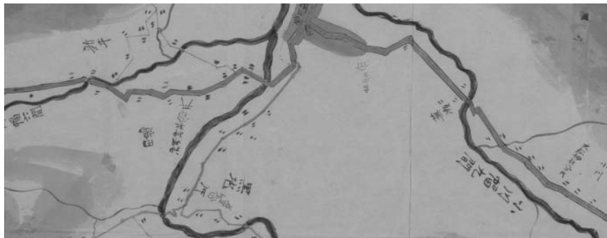
写真. 7 根羽村（一部拡大） （道路河川が屈曲して描かれ、道線法による測量がうかがえる）
