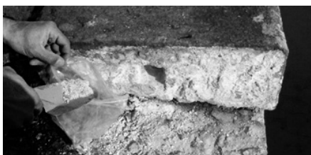
写真-9 笠石のダボ穴から発見された硫黄
