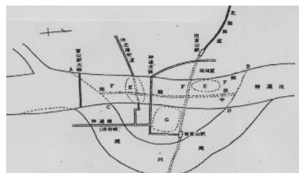
図-1 神通川馳越線工事の概念図 1)
