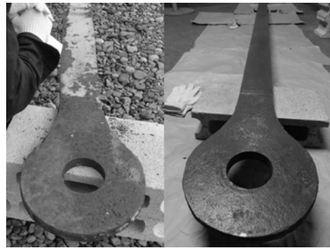
錆落とし前後の下弦材 (Eye Bar)
