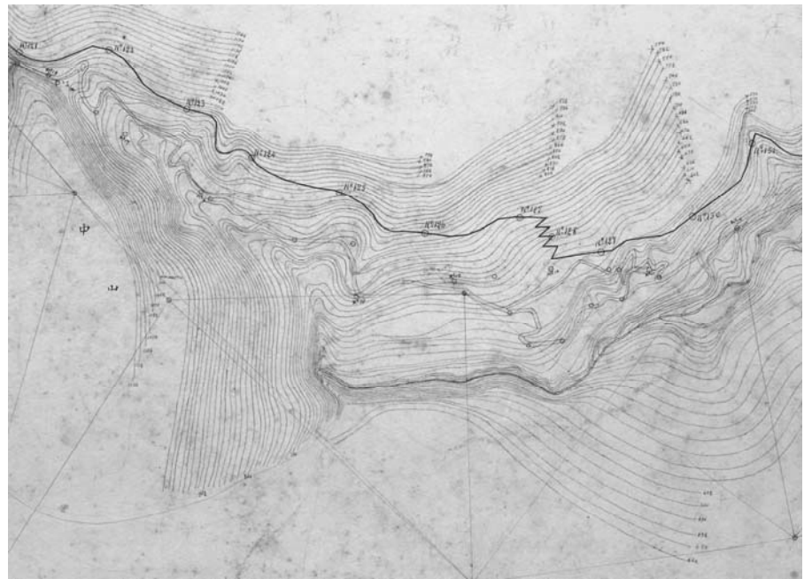
写真 2 飲用水路平面実測図 長野町外三ヶ町二係ル 縮尺 1/3000 (長野県立歴史館所蔵 長野県測量図 2683)
