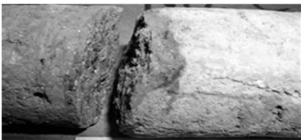
写真-1 有機質土層と砂質土層の接触面
