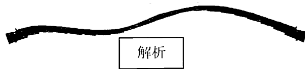
図-8 偏載分布荷重（合計45tf）時の変形
