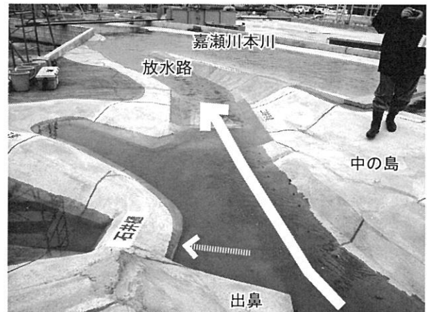
写真9 出鼻の水理模型実験（撮影：吉村）
