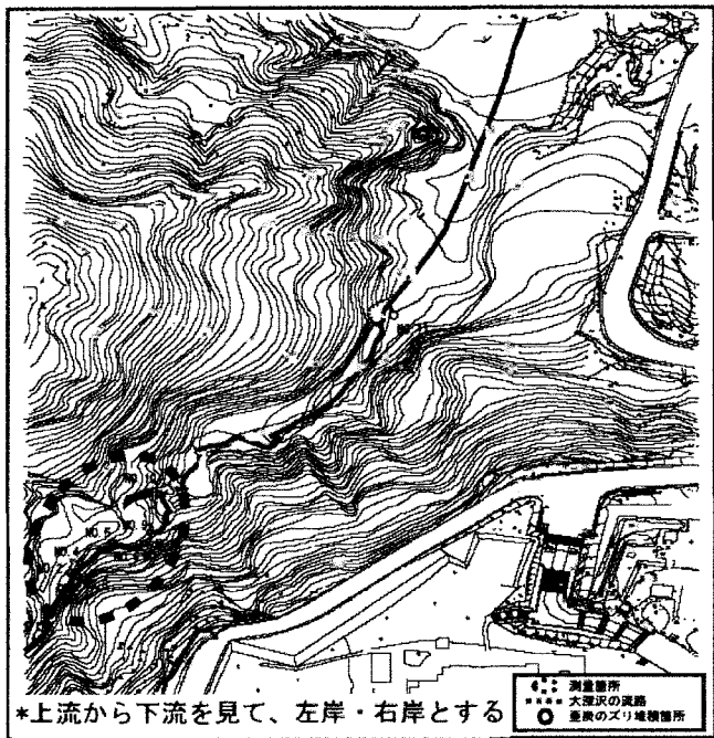
図－３ 亜炭ズリ堆積箇所細部測量位置
