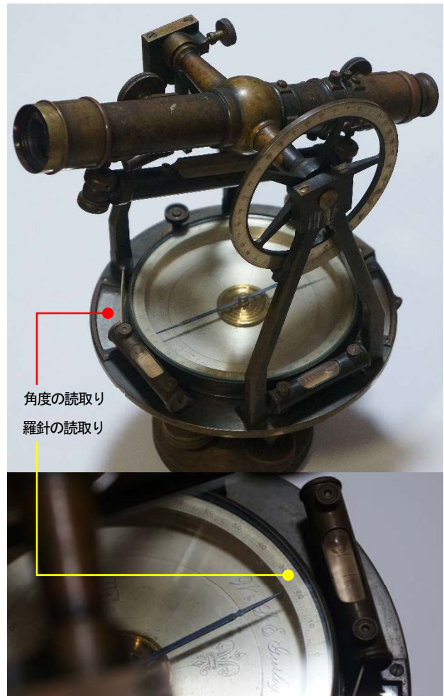
写真6 当時の標準的トランシット。5インチというのは磁針の長さを表わす。盤面サイズが方位の読取り精度を左右している認識が窺える
