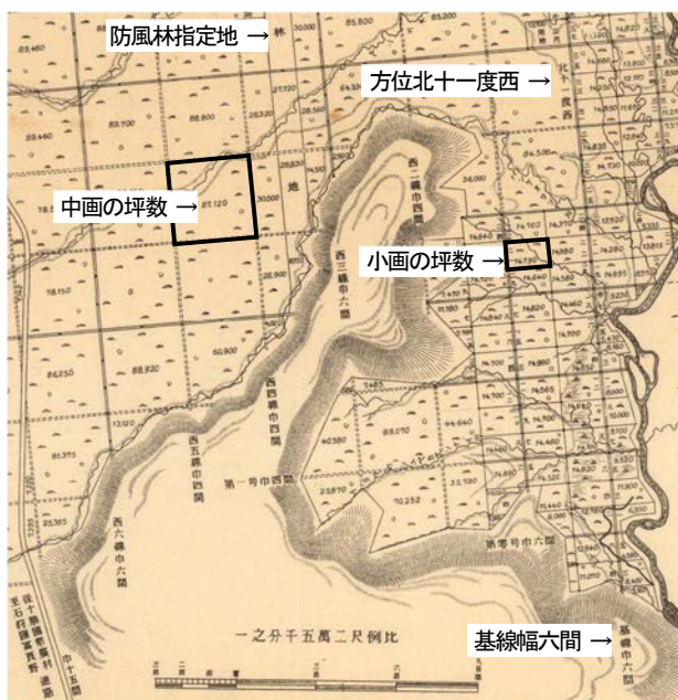
図2 区画図の例、基線とその方位、道路名、防風林等が示されている
