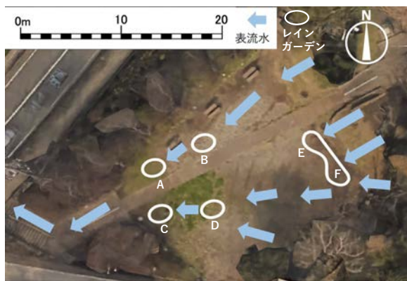
図-12 レインガーデン試験施工の配置スケッチ（上）と配置図（下）（google earth を元に加筆）．奥の斜面からの流れを斜面下で大型の貯留ピットで捕捉し、水たまりになる場所、手前の流末端近くに小型ピットを分散的に配置．
