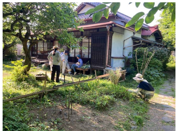
図-4 平野邸レインガーデン。雨樋から雨柵（防火用水）へ雨水を導き，オーバーフローを竹樋で庭と池へ導水する。
