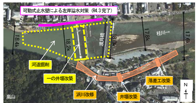
図-1 桂川嵐山地区における3つの治水対策
