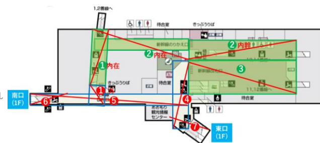
図-6 各駅の構内図に Axial Line を追記し作成した Justified Map (駅構内図出典: JR 東日本 Web ページ)
