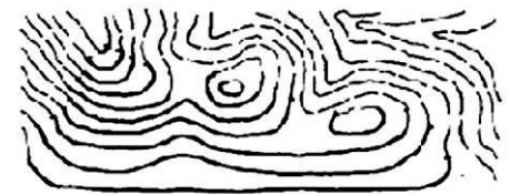
レベル3 既存地形の形状に合わせて、新たな地形を創出し、小段の設置も廃止したもの
