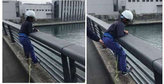
図-25 よじ登り実験状況(右は笠木を掴まない状態)
