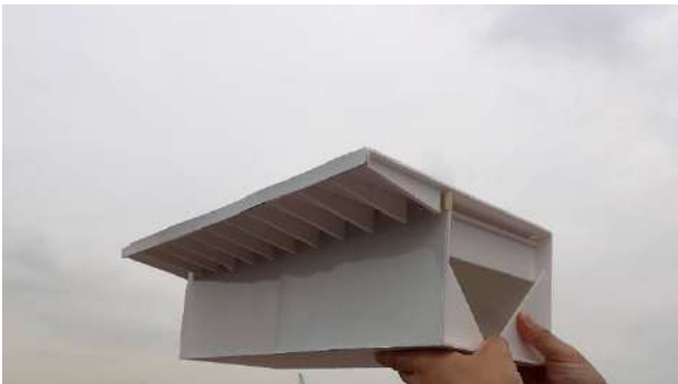
図-11 桁模型による陰影確認
