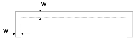
図-16 補剛材取り付け 断面図
