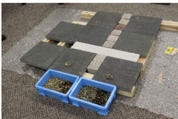
写真-2 脱色アスファルト検討過程(写真右手が豊後砂利)
